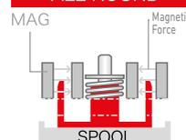
**ALLROUND** – Reduzierte Bremswirkung der Magneten. Die Spule läuft schneller und länger – die ideale Einstellung für normale Angelsituationen und mittelschwere Köder.
