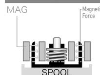
**MAX BRAKE** – Maximale Bremseneinstellung – sehr hilfreich bei Gegenwind und bei Verwendung von großen Ködern. Ein Überlaufen der Spule wird verhindert.
