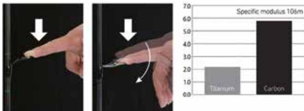
Vergleich der Steifigkeit von Carbon und Titanium: Carbon ist etwa 3x so steif wie Titanium und ist somit das ideale Material für Rutenringe – die Carbonrahmen der AGS Ringe unterstützen die Sensibilität eines Rutenblanks wie kein anderes Material.
