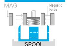
**LONGCAST** – Geringste Bremswirkung. Die Spule erreicht die höchste Geschwindigkeit von allen Grundeinstellungen. Ideal, wenn mit kleinen Ködern auf langer Distanz gefischt wird.
